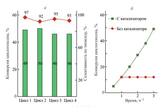
**Рис. 5.** Исследование стабильности катализатора PAF-30-NPy—Мо: a — повторное использование катализатора PAF-30-NPy—Мо;  $\delta$  — кинетика эпоксидирования циклогексена и опыт с отделением катализатора. Условия реакции. Соотношения, мол.: циклогексен:Мо = 1500:1; циклогексен:mpem-бутилгидропероксид = 1:1.5; 1,2-дихлорэтан 4 мл; 80°C; 3 ч.
