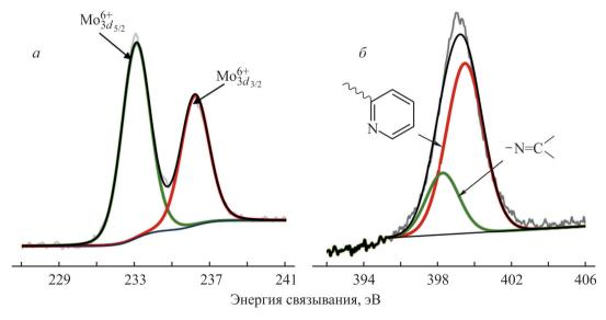
**Рис. 4.** Спектры РФЭС Мо 3*d* (*a*) и N 1*s* (*б*) для катализатора PAF-30-NPy–Mo.
