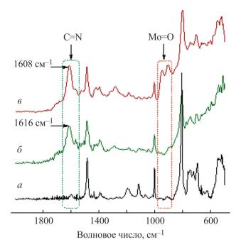
**Рис. 3.** ИК-спектры материалов: a - PAF-30,  $\delta - PAF-30-NPy$ ,  $\epsilon - PAF-30-NPy-Mo$ .
