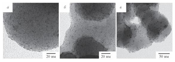
**Рис. 2.** Микрофотографии катализаторов: a - Ru-PAF-30;  $\delta - \text{Ru-PAF-30-NH}_2$ ;  $\epsilon - \text{Ru-PAF-30-SO}_3\text{H}$ .
