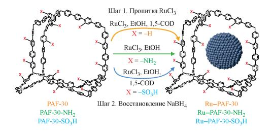
**Рис. 1.** Схема синтеза рутениевых катализаторов на основе пористых ароматических каркасов PAF-30, PAF-30-NH<sub>2</sub>, PAF-30-SO<sub>3</sub>H.
