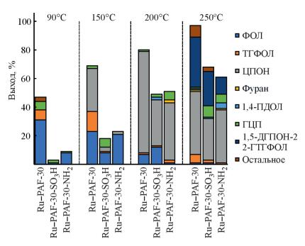
Рис. 4. Гидрирование фурфурола в среде воды на катализаторах на основе РАГ.
